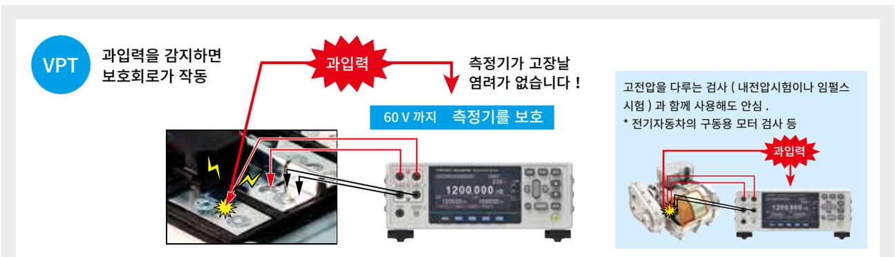
VPT 는 60V 까지 내전압과 과입력 전압을 감지하는 기능입니다. 전압이 발생한 배터리팩의 버스바를 측정하는 경우에 측정기가 고장날 것을 염려하지 않고 사용할 수 있습니다. 과입력을 감지하면 보호회로가 작동하여 즉시 측정을 정지합니다. 과입력이 사라지면 자동으로 측정을 재개합니다.
