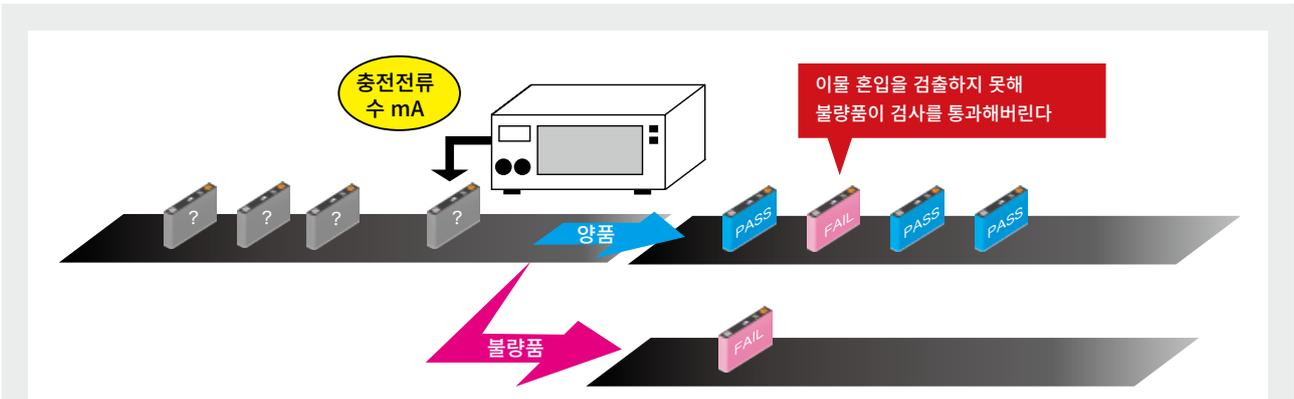
이물 혼입 ( 불량품 배터리 ) 은 충전 중에 전압의 변화가 생기기 쉬운 것으로 알려져 있습니다. 충전 중 미세한 전압 변화를 파악하기 쉽도록 하기 위해 충전 전류를 작게 하여 충전 중 전압 변화를 완화하려는 니즈가 있습니다. 이 검사 공정에서 사용되는 절연저항시험기는 대부분 큰 전류 ( 수 mA ) 를 흘려보내는 것이 많고, 전류를 제한하는 기능이 탑재된 기기는 그다지 많지 않습니다.
