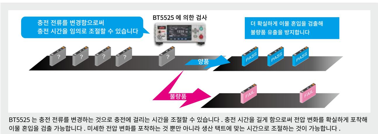
BT5525 는 충전 전류를 변경하는 것으로 충전에 걸리는 시간을 조절할 수 있습니다. 충전 시간을 길게 함으로써 전압 변화를 확실하게 포착해 이물 혼입을 검출 가능합니다. 미세한 전압 변화를 포착하는 것 뿐만 아니라 생산 택트에 맞는 시간으로 조절하는 것이 가능합니다.
