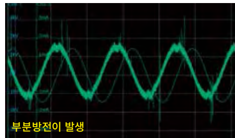
유사 불량품의 AC1.0kV 인가 시의 전류·전압파형
