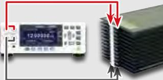
셀 접합부 · 부스바의 저항을 측정함으로써 용접품질을 확인할 수 있습니다. 용접이 불량한 경우, 연결부의 저항이 높아져 충방전 시에 큰 열 손실이 발생합니다.
