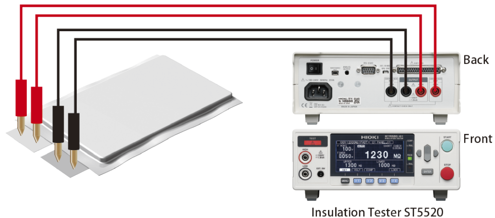
그림 13 절연저항시험기 ST5520에 의한 배터리셀의 절연저항검사
