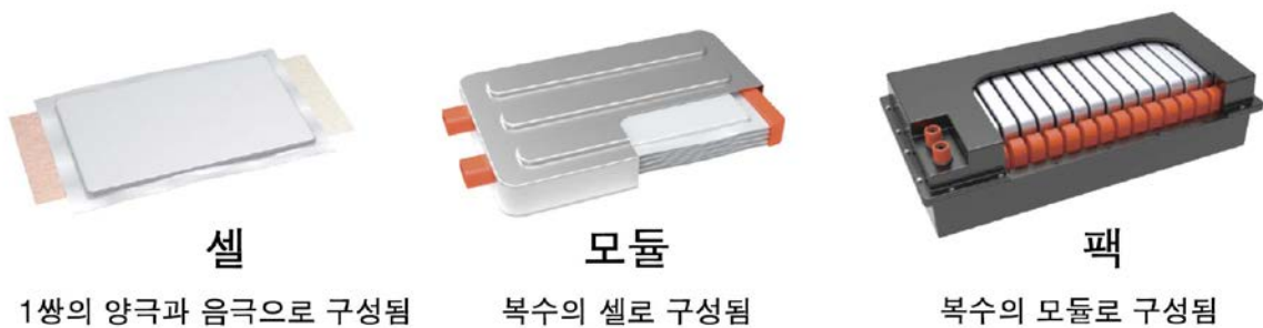
그림 39 라미네이트형 리튬이온배터리의 형태 예
